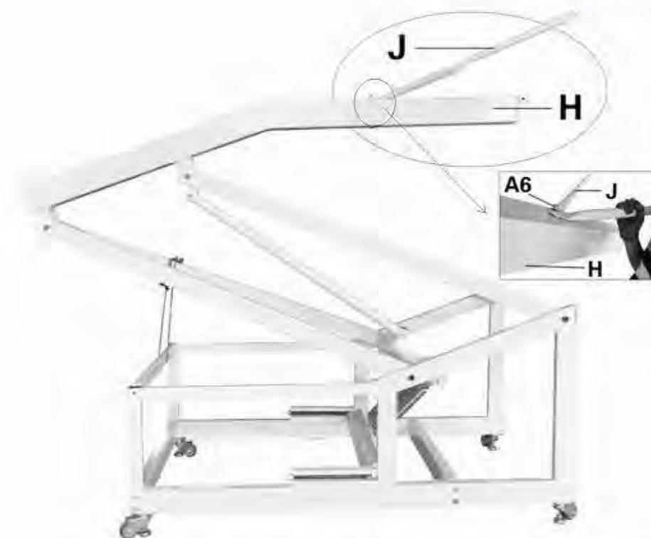
10. Используя винта (А6), вставьте более длинную часть двух трубок для крепления щита (J) в основную стойку (H). Винт (А6) следует затянуть после фиксации другой части трубок для крепления щита (J) на задней части щита (K). Примечание: 2 трубки для крепления щита (J) разделяются на правую и левую.
