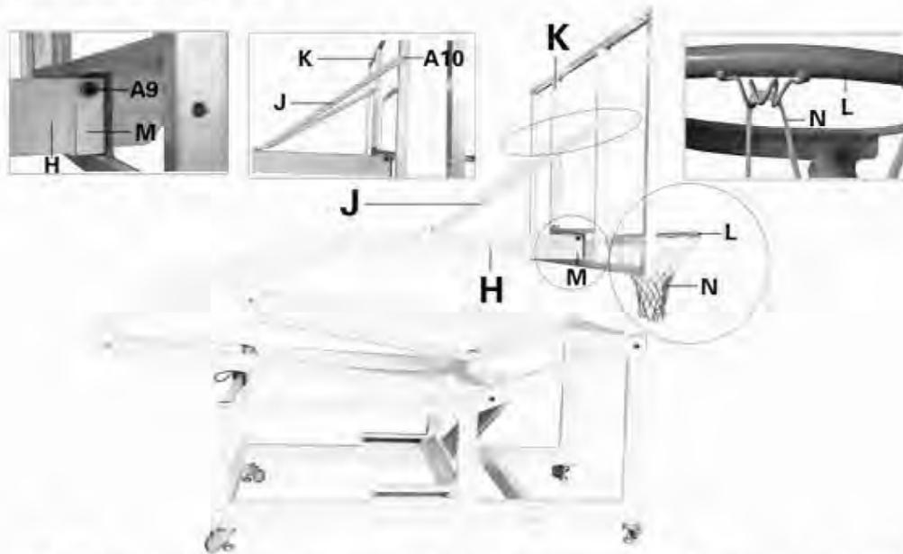
13. Полностью поднимите щит, используя винт (A9), прикрепите фиксирующую пластину (M) к передней части основной стойки (H) как показано. Затем, используя 2 винта (A10), установите 2 трубки для крепления щита (J) на задней части щита (K). Установите сетку (N) на кольцо (L).
