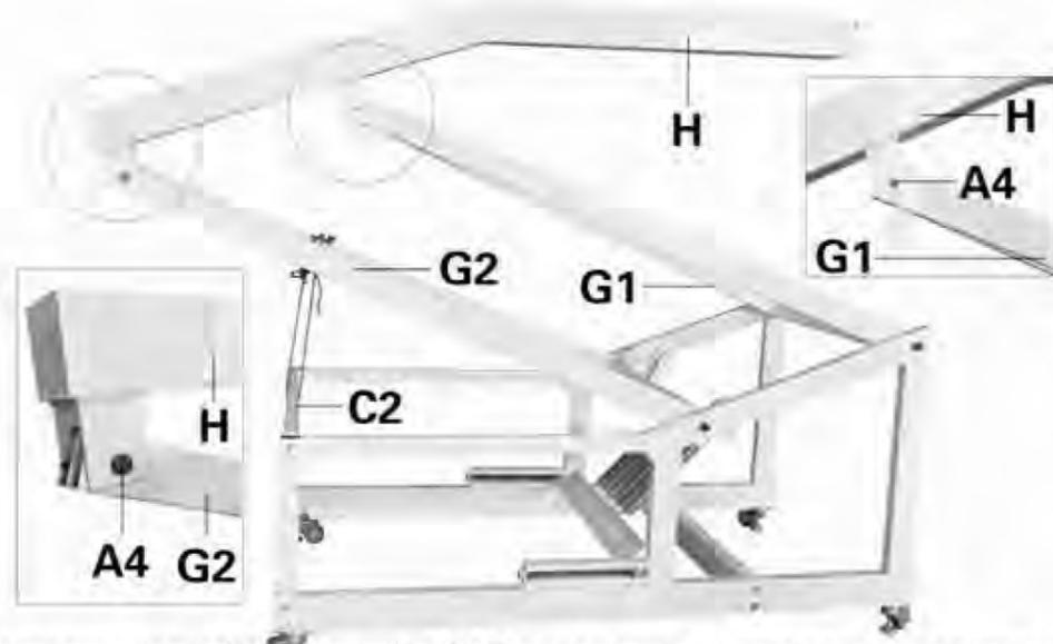
8. 1) Потяните задний кронштейн (G2) назад на сколько это возможно, затем привяжите его к верхней перекладине основания (C2) крепкой веревкой как показано. Примечание: веревка должна быть надежно зафиксирована. Очень важно!!! Внезапный разрыв пружины или веревки могут причинить серьезные травмы.
