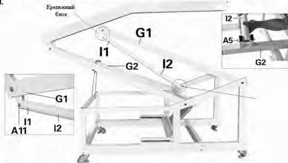
9. Используя винт (A11), закрепите подъемную штангу вверх (I1) к крепежному блоку на верхней части переднего кронштейна (G1) как показано, затем вставьте передний кронштейн (G1) в подъемную штангу вниз (I2). После этого, используя винт (A5), закрепите подъемную штангу вниз (I2) к нижней части заднего кронштейна (G2). Затем затяните гайки.
