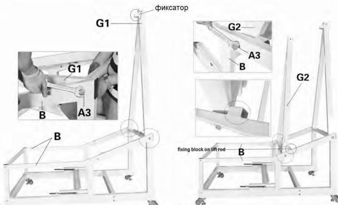
5. Закрепите передний кронштейн (G1) на верхней передней части кронштейна основания (B) с помощью 2х винтов (A3) как показано. Убедитесь, что фиксатор на верхней части переднего кронштейна (G1) находится лицевой стороной к задней части.
