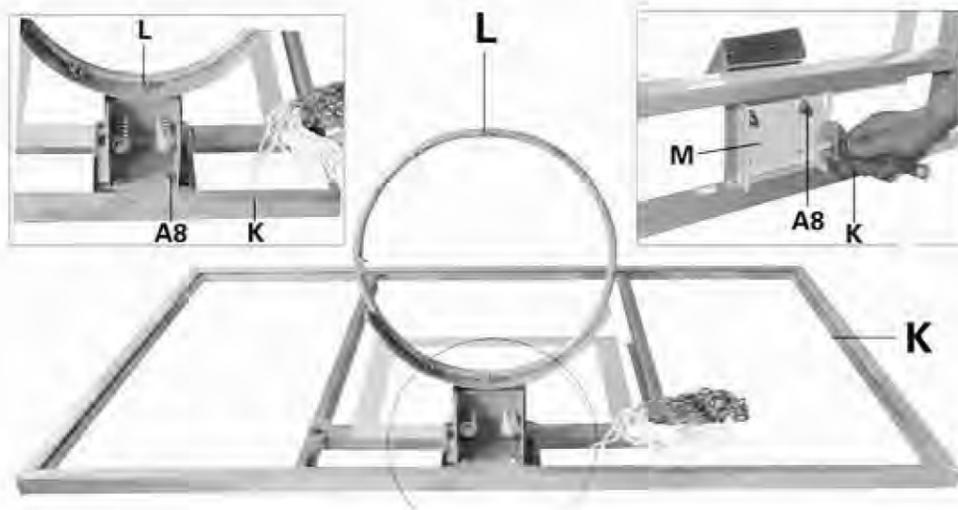
12. Удалите 2 винта и пружины с внутренней части кольца, затем установите баскетбольное кольцо (L), щит (K) и фиксирующую пластину (M), закрепив их вместе с помощью 4х винтов (A8) как показано. Примечание: два отверстия на фиксирующей пластине (M), должны быть сверху. Вставьте 2 винта и пружины обратно в кольцо (L).
