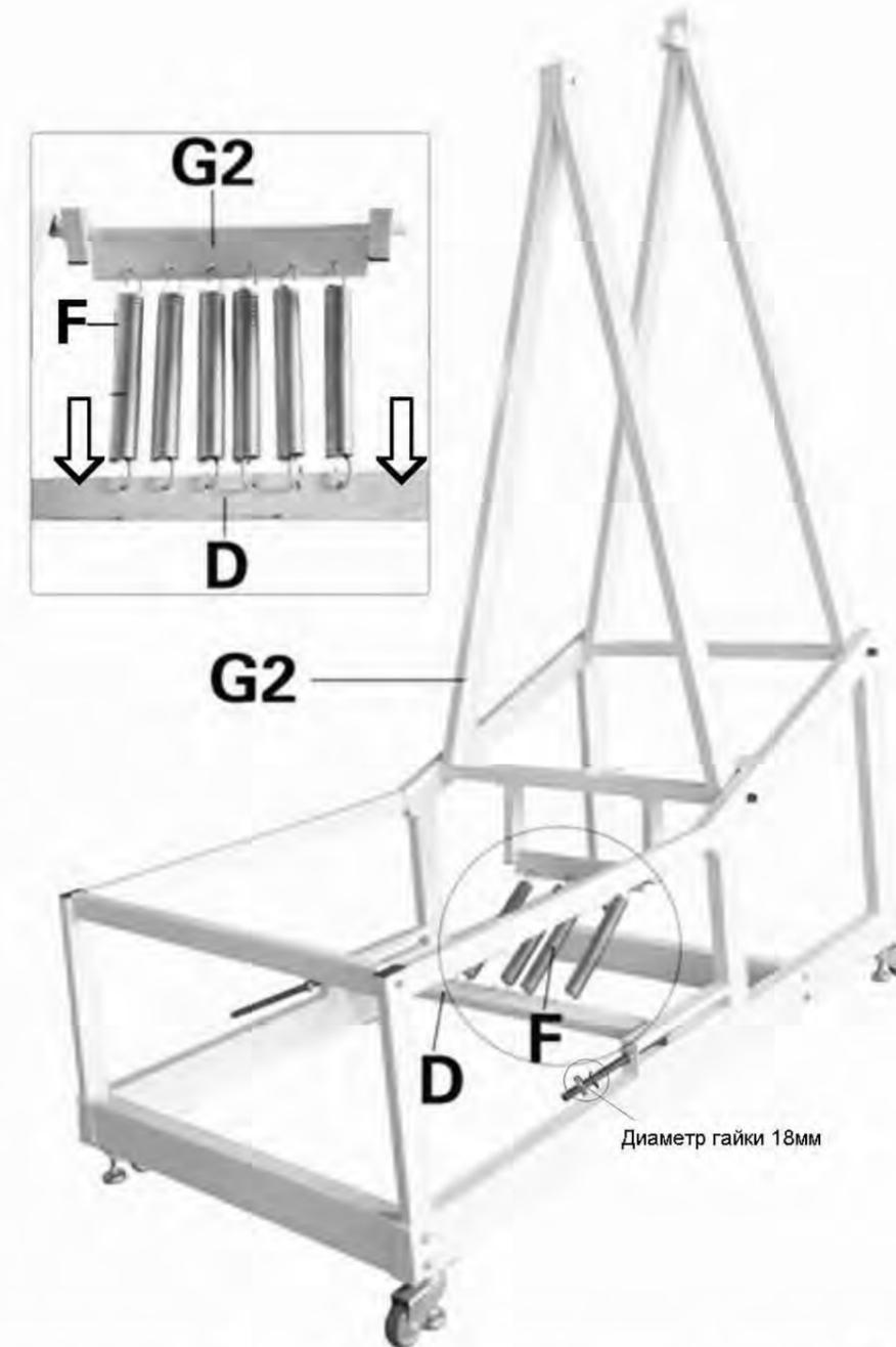
7. Установите пружины (F) как показано: Зацепите крюком 6 пружин (F) за дополнительные отверстия на заднем кронштейне (G2) и перекладины для пружины (D). Оттяните перекладину (D) в обратном направлении параллельно настолько это возможно, затяните гайку на винте (E).
