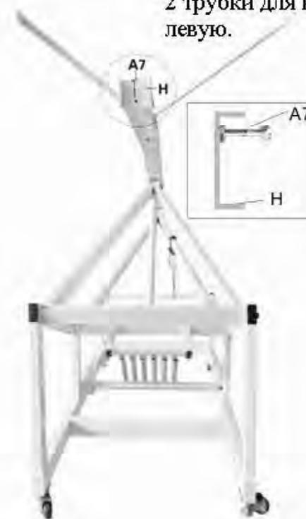
Вставьте винт (А7) в отверстие на передней части основной стойки (H) как показано, затяните винт (А7). Данный винт предназначен для регулировки щита в вертикальном положении.
